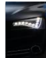
Primeiro Farol 100% LED com funções AFS juntamente com as funções de Alta e Baixa Audi A8
