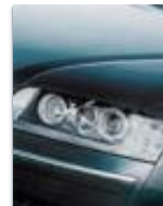
Luz de curva e luz de curva dinâmica
