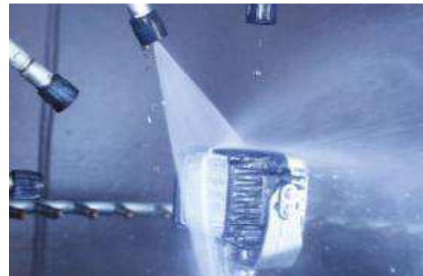
Teste de Limpeza sob Alta Pressão
