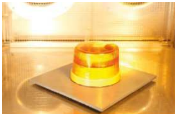
Teste de Alta/Baixa Temperatura e Umidade
