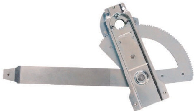
R-5229 E/D Máquina Reguladora F 1000 / F 4000 92...99 (Sapão) C/ Motor - S/ Motor - Fixação Motor Mabuchi Nº Orig. 2SA.837.501A (LE) / 2SA.837.502A (LD)
